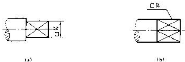
图 1-28 长方形结构的尺寸注法
